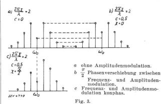
Veränderungen eines Heultonspektrums durch zusätzliche Amplitudenmodulation.
