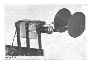
Fig. 6. Vue de la lampe et du filtre du système de mesure connecté aux deux armatures d'un condensateur.
