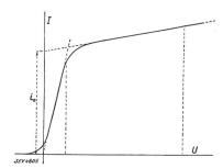
Caractéristique I = f(U) de la diode. Les deux droites obliques, tracées en poin-
