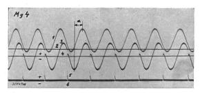
Fig. 8. Steuerung durch Sperren der Anode mit einem Magneten unter Verwendung eines Feldschwächgitters. Schaltung nach Fig. 7.
