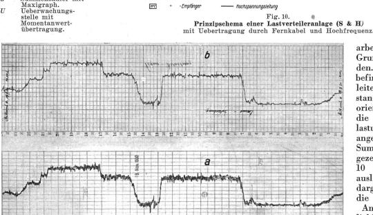
Fig. 11. Vergleichsmessung (S & H). a Mit normalem Tintenschreiber am Sendeort aufgenommen, b Fernübertragener Messwert mit Registrierempfänger aufgenommen.
