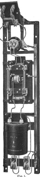
Hochspannungstelephon (S & H). (Sicherungseinrichtung).
