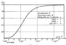
Die Abhängigkeit der Schirmwirkung  $S_{\overline{O}}$  vom Produkt {Blechstärke (mm) × Leitwert  $\begin{pmatrix} \sigma_{\mathbf{C}u} = 55.5 \\ \sigma_{\mathbf{Z}u} = 16.6 \end{pmatrix}$  × Frequenz (s-1)}
