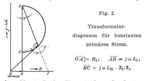
kundärwicklung). In ihm fliesst ein Strom 32, der im wesentlichen zum Spulenstrom 31 gegenphasig verläuft, und dessen Feld 1) innerhalb der Spule das Feld schwächt, d. h. die Induktivität verkleinert (innere induktive Rückwirkung), 2) zwischen Spule und Schirm das Feld vergrössert, und 3) ausserhalb des Schirmes das Feld verkleinert (äussere Rückwirkung; Schirmwirkung des Kurzschlussringes). Aeussere und innere Rückwirkung sind untrennbar miteinander verknüpft.
