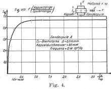
Die äussere Rückwirkung bei veränderlicher Kapsellänge.  $(S_{\bf 5}$  Schirmwirkung, bezogen auf die Feldstärke  ${\bf 5}$  in der Axe.)
