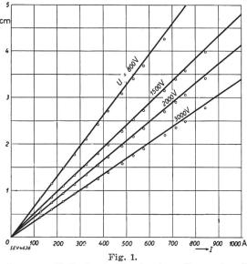
Ablenkung von Kathodenstrahlen in einem Braunschen Rohr durch einen stromdurchflossenen Leiter in Abhängigkeit vom Strom I im Leiter und Kathodenspannung U.
