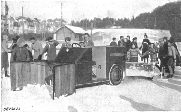
Fig. 1. Eistraktor der Ka-We-De Bern im Betrieb. Ausführung mit einem Lenkrad.
