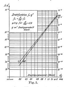
Trägt man diese Werte in einem doppelt-logarithmisch geteilten Achsensystem auf (Fig. 5), dann erhält man nahezu gerade Linien, die auch die Interpolation erleichtern.
