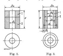
Bei der Spulenanordnung Fig. 3, die für die Ausführung bequemer ist, wird  $l_2 > l_1$ .
