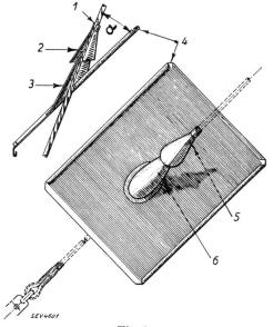
Fig. 1. Kegelförmige Dachankereinbindung, die schlechte Resultate ergab.
