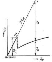
Fig. 4. Ableiter-Klemmenspannung in Funktion der Priifwellenhöhe.
