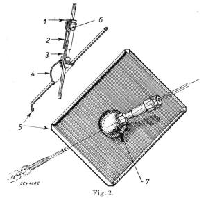
Dachankereinbindung mit Halbkugel und Stopfbüchse, die sehr gute Resultate ergab.
