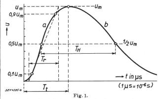
Die charakteristischen Grössen des Spannungsstosses. a Front; b Rücken.
