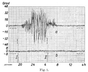
24stündige Registrieraufnahme zum Vergleich der Kursschwan-kungen der Schleifenantenne und der von Diamond entwik-kelten Antenne (transmission line-antenna) der Funkbake in Bellefonte. a Schleifenantenne. b Neues System.
