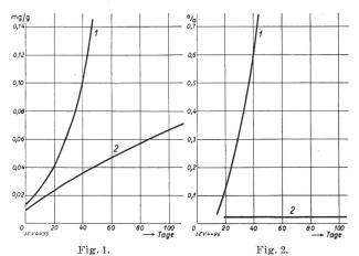
Zunahme des Säuregehaltes in mg Na OH pro g Flüssigkeit bei Dauerversuch. 1 Mineralöl bei 120° C. 2 Pentachlor-Diphenyl bei 150° C. Fig. 2.
