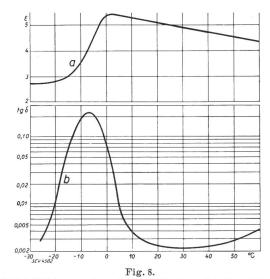
Dielektrizitätskonstante  $\varepsilon$  (a) und Verlustwinkel tg  $\delta$  (b) von Pentachlor-Diphenyl in Funktion der Temperatur, bei 60 Per./s.
