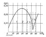
Fig. 6. Fig. 7. Einfluss des Chlorierungsgrades (% Gewichtsanteil des Chlors) von Diphenyl auf die Dielektrizitätskonstante  $\varepsilon$  (Fig. 6) und auf den Verlustwinkel tg  $\delta$  (Fig. 7).
