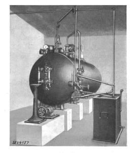
Fig. 10. Elektro-Dampfkessel, 6000 V, 2000 kW.
