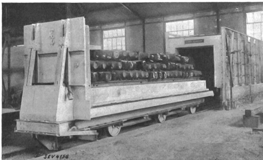
Fig. 11. Glühofen für Eisenknüppel, 350 kW.
