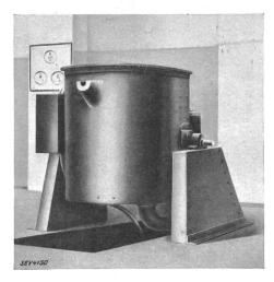
Fig. 2. Niederfrequenz-Induktionsofen für 600 kg Einsatz.
