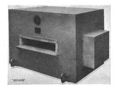
Fig. 5. Schmiedeofen mit Silitbeheizung, 12 kW.
