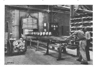
Fig. 6. Emaillierofen mit Schnelladevorrichtung, 110 kW.
