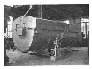
Fig. 3. Widerstandsschmelzofen für Aluminium, 200 kW.
