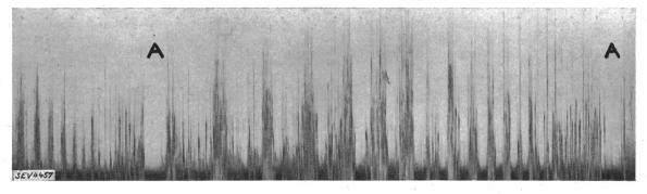
Fig. 2. Störungsdiagramm einer Strassenbahn mit zweidrähtiger Fahrleitung. Abstand der Aufhängepunkte «A»: ca. 30 m; Oszillogramm beginnt links; Aufnahmedauer ca. 9 s.
