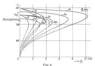
Belastung des durch Kondensatoren selbsterregten Asynchrongenerators.
