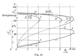
Belastung des durch Kondensatoren selbsterregten Asynchrongenerators.
