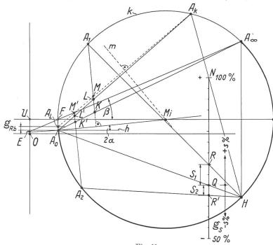
Fig. 11. Admittanzkreis einer fremderregten Asynchronmaschine; Klemmenspannung konstant. s = Schlüpfung (%).
