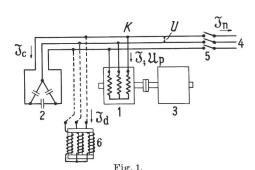
Schema des durch Kondensatoren selbsterregten Asynchrongenerators.
