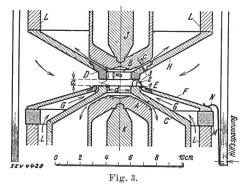
Schnitt durch eine Elektrodenanordnung für Hilfslichtbogenzündung. Der Hilfslichtbogen entsteht zwischen der Schirmelektrode C und der Zündelektrode E und nimmt nacheinander die Stellungen 1, 2 und 3 ein.
