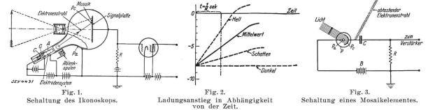
Photostrom von  $10^{-5}/10\cdot70\ 000 = 1,43\cdot10^{-11}$  A, d. h. eine Ladung pro Bildelement von  $1,43\cdot10^{-11}/1,4\cdot10^6 = 10^{-17}$  Coulomb. Verglichen mit der Ladung eines Elektrons  $(1,59\cdot10^{-19}$  Coulomb) bedeutet das, dass nur 63 Elektronen während des
