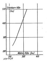
Fig. 2. Errechnetes Verhältnis der wahren zur scheinbaren Höhe für  $\lambda=70$  m. (Försterling und Lassen.)
