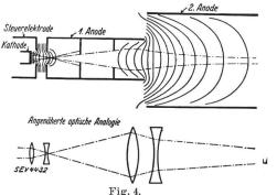
Elektrostatisches Feld des Elektrodensystems im Ikonoskop.
