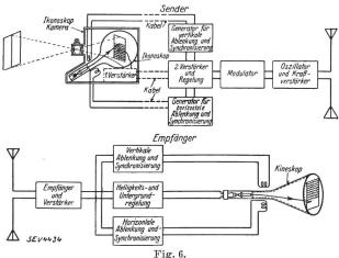
Schaltung einer vollständigen Fernseh-Sende- und Empfangsanlage.
