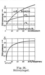
funden, dass beim Amplitudenverfahren blank verbleibende Bereich des Tonstreifens bis zum Wellenzug abgedeckt wird. Bei sehr kleiner Tonamplitude ist dann eine weitgehende Abdeckung der störenden Streifenhälfte möglich: Der Störpegel wird sehr klein. Die Abdekkung wird durch eine zweckmässige Apparatur bei zunehmender Tonamplitude vermindert, und der ursprüngliche Störpegel tritt erst bei
