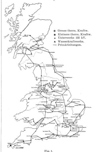
132-kV-«Primärleitungen» des Central Electricity Board.
