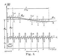
Gleichstromkomponente bei ruhendem Bilde und bei überlagerter Wechselbelichtung tiefer Frequenz.
