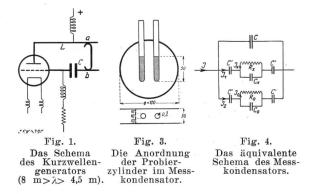
Erwärmung diverser Medien im hochfrequenten Kondensatorfeld vergrössert, wenn man diese Medien fein zerkleinert (z. B. Kohle massiv und Kohlepulver).
