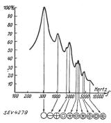
Fig. 15. Resonanzen einer Membran.
