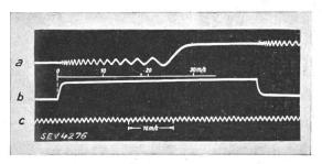
Fig. 12. Gleichstromstoss über ein Phasenausgleichglied. a Hinter dem Glied. b Vor dem Glied. c Zeitkurve.
