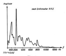
Fig. 1. Geräusch eines Staubsaugers.
