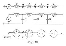
mente und die Kirchhoffschen Gesetze bestimmend sind, so kann also jedes linear ausgedehnte mechanische System mit vollkommener Analogie durch ein elektrisches Ersatzschema dargestellt werden, wobei z. B. der ideale elektrische Transformator einem mechanischen Hebel entspricht.
