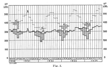
Verlauf der monatlichen hydraulischen Energieproduktion. mögliche hydraulische Energieproduktion (siehe auch Text). wirkliche hydraulische Energieproduktion, wovon c aus
