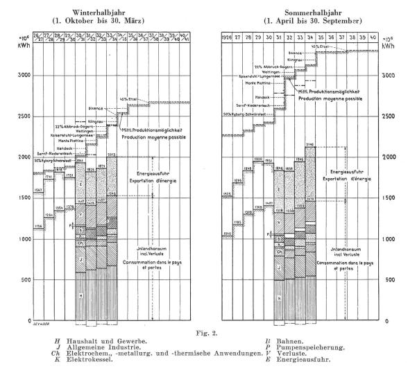
Fig. 2 gibt einen Ueberblick über die in den Wasserkraftwerken, bei mittlerer Wasserführung technisch mögliche Energieproduktion, den Inlandkonsum und die Energieausfuhr pro Winterund Sommerhalbjahr seit dem Jahre 1926/27. Für die 4 letzten Winter- und Sommerhalbjahre ist die Abgabe an die verschiedenen Verbraucherkategorien auf Grund der seit 1. Oktober 1930 neu eingeführten Erhebungen angegeben.
