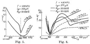
Variation de la fréquence de l'oscillateur en fonction de la fréquence propre du circuit de grille.  $\begin{array}{cccc} \text{Variation de la fréquence} \\ \text{ en fonction de } C_{\mathfrak{g}} \ . \end{array}$
