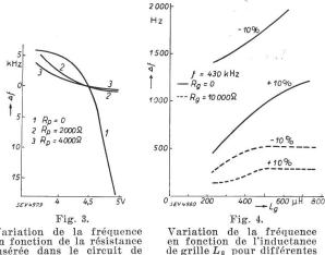
Variation de la fréquence en fonction de la résistance insérée dans le circuit de plaque et de la tension de chauffage (abcisse).
