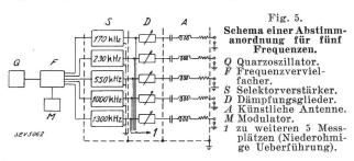
einrichtung, mit welcher gleichzeitig bis zu 10 Empfänger abgestimmt und auf ihre Empfindlichkeit gemessen werden können. Q stellt einen Quarzoszillator dar, dessen Verstärkerstufe F als Frequenzvervielfacher arbeitet. Hinter diese Vorstufe sind 5 selektive Hochfrequenzverstärker S geschaltet. Diese arbeiten auf 170, 230, 550, 1000 und 1300 kHz und geben mit einer Dämpfungseinheit D eine von der Belastung unab-
