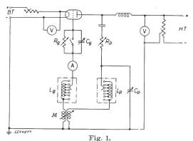
Schéma de l'oscillateur expérimental.
