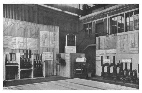
Fig. 1. Ausstellung von Druckluftschaltern.
