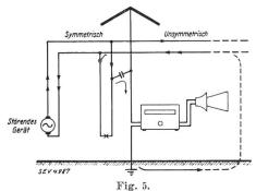
Entstehung unsymmetrischer Störströme durch Netzunsymmetrien.
