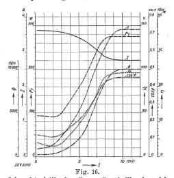
Anlaufcharakteristik der Osram-Quecksilberdampf-Lampe, Typ Hg H 1000, bei Nennspannung. Lampe Nr. G 2769, Drosselspule Osram S Nr. W 4964 E. I Stromstärke,  $P_{\text{T}}$  totale Leistungsaufnahme,  $\Phi$  Lichtstrom,  $U_{\text{L}}$  Lampenspannung,  $\cos \varphi$  Leistungsfaktor,  $\eta$  Lichtausbeute, f=50/s.
