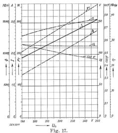
Betriebscharakteristik der Quecksilberdampf-Lampe, Typ Hg H 1000. Lampe Nr. 5635, Drosselspule ELZ Nr. 581. (Kurvenbezeichnung wie Fig. 16.)
