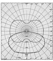
Fig. 5. Lichtverteilungskurven des Belmag-Breitstrahlers, 22 150 mit Natriumdampf-Lampe, Typ S O, 100 W.
