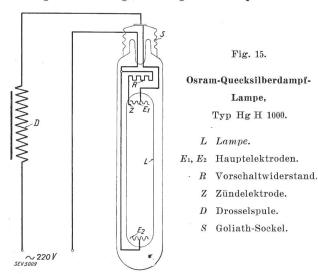
Stromzuführungen und ist mit dem normalen Goliath-Sockel S versehen. Da die Zündspannung unter der Netzspannung 220 V liegt, kann die durch die negative Charakteristik bedingte Strombegrenzung durch eine Drosselspule D erfolgen.
