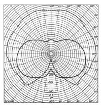
Fig. 22. Lichtverteilungskurven der BAG-Plaza-Leuchte 7265, mit innenmattierter Glühlampe 220 V, 300 W.
