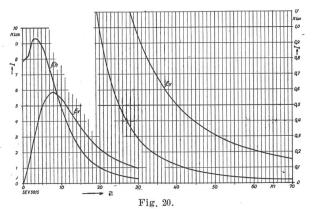
Beleuchtungskurven des Belmag-Freistrahlers 9 mit Quecksilberdampf-Lampe, Typ Hg H 1000.
