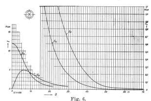
Beleuchtungskurven des Belmag-Breitstrahlers, 22 150, mit Natriumdampf-Lampe, Typ S O, 100 W.
