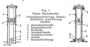
sen am Rohr Metallringe aufgebracht, welche, indem sie ein Zwischenpotential annehmen, die Rolle von Feldsteuerringen übernehmen. Dies hatte zur Folge, dass nun das Rohr bis zu 75 kV bei 5 mA völlig ruhig arbeitete.
