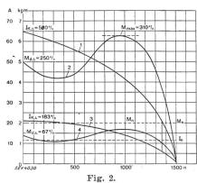
ner anknüpfen und Ihnen an Hand eines konkreten Beispiels zeigen, wie sich ein- und derselbe Motor sowohl im Anlauf als auch im Betrieb verhält, wenn er nacheinander mit verschiedenen Rotoren ausgerüstet wird. Ich habe hiezu einen 4poligen Kurzschlussankermotor für eine Leistung von 3 kW bei 220 Volt verketteter Spannung und 50 Per./s. gewählt,
