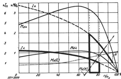
Fig. 3. Drehstrom-Kurzschlussankermotor in  $\Lambda$  und  $\Delta$ -Schaltung.
