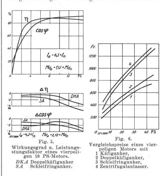
tes von 152 % auf 212 % des Nenndrehmomentes; bei Anlauf in Stern-Dreieck würde der letzte Motor mit ca. 1,4fachem Nennstrom rund 70 % des Nennmomentes entwickeln, was für die meisten Antriebe genügen dürfte. In Fig. 6 sind die Preise für Motoren bis zu 30 kW in den verschiedenen Ausführungsarten aufgetragen; der Mehrpreis für die Motoren mit Spezialanker ist gering; als teuerste Variante erscheint der gewickelte Anker mit Anlasser, dessen Preis zu 70 bis 140 Fr. pro PS
