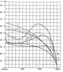
Fig. 3. Schaltung Dreieck. Anlauf mit verschiedenen Rotoren. Dreiphasenmotor 3 kW, 220 Volt  $\triangle$ , f = 50, n = 1500.
