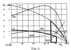
Drehstrom-Kurzschlussankermotor in ↓ und △ -Schaltung.
