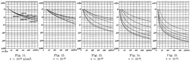
Feldstärke der Bodenwelle (mV/m) in Funktion der Distanz für eine ausgestrahlte Leistung von 1 kW bei verschiedenen Frequenzen (nur in Fig. 11 angegeben; für Fig. 12 bis 15 gilt die gleiche Kurvenbezeichnung).
