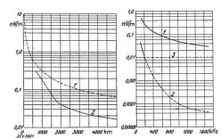
Fig. 6. 1 Kurve der reziproken Distanz. 2 Verlauf der Feldstärke bei Nacht. Ausgestrahlte Leistung 1 kW.
