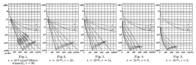
Feldstärke (m V/m) in Funktion der Distanz für eine ausgestrahlte Leistung von 1 kW.
