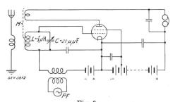
Fig. 3. Superregenerative chaltung. PF = Pendel frequenz.
