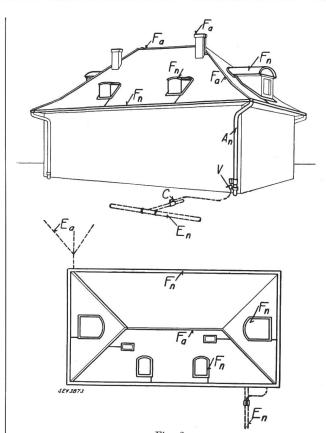
Fig. 2. Beispiel einer Gebäudeblitzschutzanlage.
