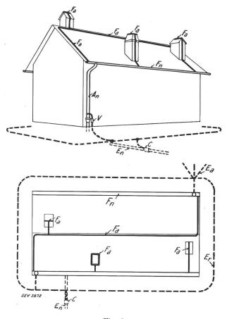
Fig. 1. Beispiel einer Gebäudeblitzschutzanlage.
