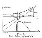
Eine Generatorschaltung ist ganz allgemein nur schwingfähig, wenn sich die Spannungen an Gitter und Anode in Gegenphase stehen. In der Huth-Kühn-Schaltung ist das nur der Fall, wenn, wie durch die Dreipunktschaltung angedeutet, die beiden Kreise induktive Widerstände aufweisen. Wenn sich eine Welle erregen soll, so kann es demnach nur eine Welle sein, deren
