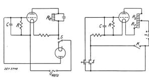
Fig. 6. Wie Fig. 3, jedoch mit Glimmlicht-Gleichrichter zur Aufladung des Kondensators.
