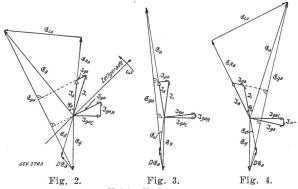
$\begin{array}{c} \text{Vektordiagramme.} \\ \mathfrak{R}_{a} = \text{kapazitiv,} & \mathfrak{R}_{a} = \text{rein ohmisch,} \\ \varphi_{a} = 45^{\circ} \text{ voreilend.} & \varphi_{a} = 0^{\circ}. & \varphi_{a} = 45^{\circ} \text{ nacheilend.} \end{array}$
