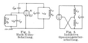
Der Bereich, in dem Schwingungen auftreten können, ist nach Barkhausen<sup>2</sup>) auf folgende einfache Art zu überblicken: Die Schaltung ist im Prinzip auf die einfache Spannungsteilerschaltung von Fig. 6 zurückzuführen.
