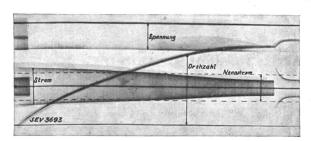
Fig. 1. Anlauf gegen grosse Schwungmassen. Kurze Umschaltzeit. Einschaltstromstoss  $\sim 1.4$  · Nennstrom. Umschaltstromstoss  $\sim 1.6$  · Nennstrom.
