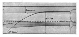
Fig. 4. Anlauf gegen kleine Schwungmassen. Kurze Umschaltzeit. Einschaltstromstoss  $\sim 1.4$  · Nennstrom. Umschaltstromstoss  $\sim 2.3$  · Nennstrom.
