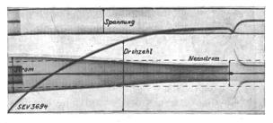
Fig. 2. Anlauf gegen grosse Schwungmassen. Lange Umschaltzeit. Einschaltstromstoss  $\sim 1.4$  · Nennstrom. Umschaltstromstoss  $\sim 2$  · Nennstrom.
