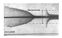
Fig. 7. Leeranlauf gegen kleine Schwungmassen. Einschaltstromstoss  $\approx 1.6 \cdot \text{Nennstrom.}$  Umschaltstromstoss  $\approx 1.5 \cdot \text{Nennstrom.}$
