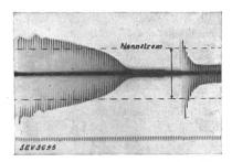
Fig. 6. Leeranlauf gegen kleine Schwungmassen. Einschaltstromstoss  $\sim 1.6 \cdot \text{Nennstrom}$ . Umschaltstromstoss  $\sim 1.5 \cdot \text{Nennstrom}$ .
