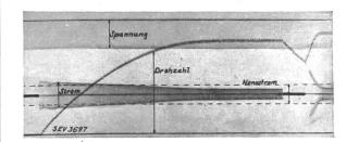
Fig. 5. Anlauf gegen kleine Schwungmassen. Lange Umschaltzeit. Einschaltstromstoss  $\sim 1.4$  · Nennstrom. Umschaltstromstoss  $\sim 2.8$  · Nennstrom.
