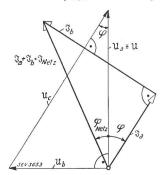
Fig. 2. Vektordiagramm eines C-Motors im «ausgeglichenen» Betriebszustand.
