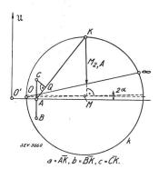
Fig. 10. Anzugs-Drehmoment des C-Motors:
