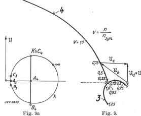
Vektordiagramm der Spannungen an der Hilfswicklung: Ub und am Kondensator: Uc der beiden bereits in Fig. 7 und 8 untersuchten C-Motoren (3, 4). In Fig. 9a ist das Kreisdiagramm des zugrundegelegten Zweiphasenmotors (1) mit den die C-Motoren (3, 4) charakterisierenden Polen A, B, C (s. Gl. 13, 14).
