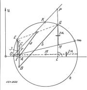
Fig. 4. Bestimmung der Drehmomente und Verluste (s. Gl. 17—22). k ist das Kreisdiagramm des zugrundegelegten Zweiphasenmotors,  $\overline{O} \infty$  seine Momentgerade,  $\overline{OK}$  seine Leistungsgerade,  $\operatorname{tg} \alpha = \frac{J_0 R_1}{I}$ Der Kreis k' (s. Fig. 3) ist der Uebersichtlichkeit wegen ausgelassen.
