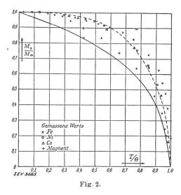
schon bei Temperaturen wenig unterhalb des Curie-Punktes durch ein äusseres Feld nicht mehr wesentlich beeinflusst werden kann. Diese spontane Magnetisierung ist gleichbedeutend der in der Technik bei Feldern von der Grössenordnung von 100 Oersted erreichten Sättigung. Wir bezeichnen sie daher kurz als die technische Sättigung. Darüber hinaus kann die Magnetisierung nur noch mit extrem hohen Feldern gesteigert werden.
