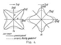
und Nickel in vektorieller Darstellung wiedergegeben, und zwar für alle Richtungen einer Grundfläche des Kristallgitters. Vom Koordinatenursprung aus ist als Vektor in der zugehörigen Richtung die magnetische Kristallenergie eingetragen; die Endpunkte dieses Vektors liegen auf der ausgezogenen Kurve. Die kleinste freie Energie kommt bei Eisen der Würfelkante [100] zu. Dies entspricht dem Umstand, dass beim Eisenkristall die Richtung der Würfelkante eine Richtung leich-
