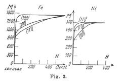
Wie wir sehen, ist die Magnetisierbarkeit in den verschiedenen Richtungen verschieden. Eisen lässt sich besonders gut in Richtung der Würfelkante [100] magnetisieren, Nickel dagegen in Richtung der Körperdiagonale [111]. Schon für kleine aufgewendete Feldstärken ist in diesen Richtungen bereits die Sättigung erreicht; während in den andern Gitterrichtungen die Sättigung grösserer Feldstärken bedarf.
