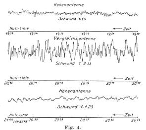
Schwundkurven der Höhen- und Vergleichsantenne bei 60 km.  $\lambda = 192$  m.
