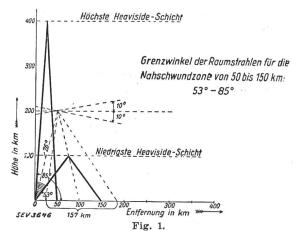
Einfluss der Höhe und Neigung der Kennelly-Heaviside-Schicht auf die Raumstrahlenwinkel, die den für den Nahschwund beobachteten Entfernungen entsprechen.
