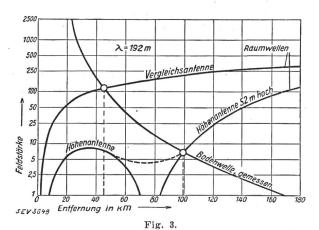
Feldstärkenkurven der Boden- und Raumwellen der Höhen-antenne der Versuche in Eberswalde. Feldstärke in V/m.
