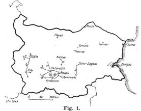
Plan der Hochspannungsleitungen Bulgariens. (Die Zahlen bei den Leitungen bedeuten die Spannung in kV.)
