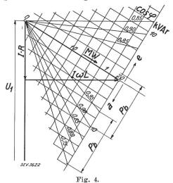
Spannungsdiagramm bei konstanter Belastung.
