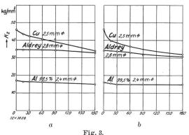
Einfluss einer Erwärmung während 180 Tagen auf die Zugfestigkeit von Kupfer-, Reinaluminium- und Aldreydrähten (Festigkeit in Funktion der Erwärmungsdauer).
