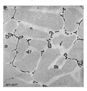
Fig. 2. Wie Fig. 1, aber während 30 Minuten auf 520° C geglüht.
