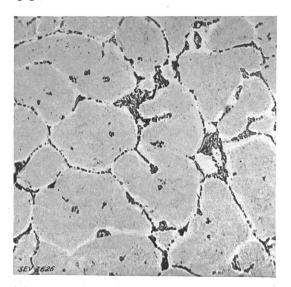
Fig. 1. 250fache Vergrösserung eines Schliffes von Aldrey, das während 15 Minuten auf 520° C geglüht, dann abgekühlt und dann während 4 Stunden auf 150° C angelassen wurde.
