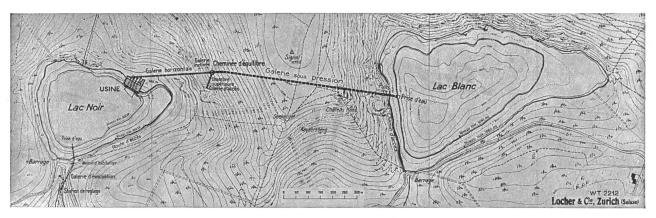
Fig. 1. Lageplan des Speicherkraftwerkes Lac Noir.
