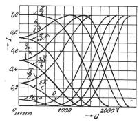
Fig. 5. Lichtstärke (I) Funktion der Kerrzellenspannung (U in Volt).
