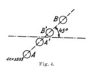
des Analysators ab, so dass es möglich ist, durch geeignete Wahl der Dickenverhältnisse die Punkte A und B' zur Deckung in der zweiten Blendenöffnung zu bringen, von welcher die Projektionslinse über ein rotierendes Spiegelrad ein Bild auf dem Projektionsschirm entwirft. Diese Anordnung vermeidet die früher aufgezählten Nachteile:
