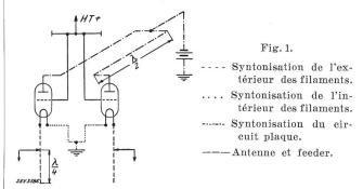
Barkhausen et Gill Morell avec un système Lecher entre la plaque et la grille adopté d'abord, a bientôt été abandonné en faveur d'un nouveau circuit symétrique à deux lampes (fig. 1). Le nouvel oscillateur électronique est caractérisé par trois circuits syntonisés bien définis, soit les circuits intérieurs et extérieurs des filaments et le circuit plaque, et, en outre, par l'emploi d'un feeder qui permet d'adapter une antenne dipôle efficace à l'impédance des valves.
