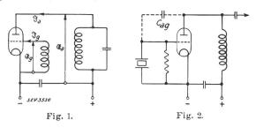
Um frequenzstabile Oszillatoren zu bauen, stehen uns nun 5 prinzipiell verschiedene Wege offen, nämlich: 1. Feste Oszillatoren mit Schwingquarz, 2. Quarzoszillatoren mit Verstimmung, 3. Oszillatoren mit kleiner Impedanz des Schwingungskreises, 4. Selektive Rückkopplung, 5. Phasenkompensierte Oszillatoren.
