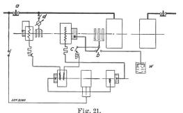
Schaltschema der Asynchronmaschine mit Kaskade.
