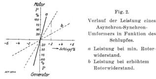
schen zwei Netzen über einen Synchron-Asynchron-Umformer zirkulierenden Leistung in Abhängigkeit der an den Schleifringen des Asynchronmotors entstehenden Schlupfspannung würde deshalb nach Fig. 2 verlaufen.
