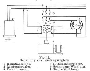
wicklung an die dritte Phase der Regler als Wattmeter. Wird nun das Wattorgan, wie angegeben, mit dem Servomotor bzw. mit dem Induktionsregler sinngemäss gekuppelt, so dass bei Drehung der Ferrarisscheibe entsprechend steigender Last der Induktionsregler im gegenteiligen Sinne, d. h. auf sinkende Last verstellt wird, so kommt die Reguliereinrichtung immer beim Leistungswert 0 zum Still-
