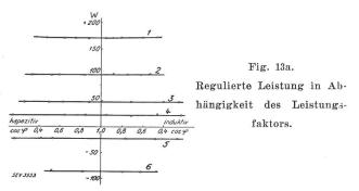
der Vorschaltwiderstand gleich dem Parallelwiderstand. Fig. 13a zeigt, dass die Leistungsregulierung vollkommen unabhängig vom Leistungsfaktor ist.
