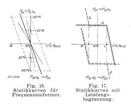
Lastverteilung von parallel arbeitenden Aggregaten durch die entsprechenden Werte der Statik ergibt, muss dieser Wert von 0 bis zu einem gewissen Maximum ebenfalls einstellbar sein (Fig. 16). Die Einstellung einer bestimmten Last erfolgt wie beim Turbinenregler mit der Drehzahl- bzw. Frequenzverstellvorrichtung. Für eine gegebene, konstant angenommene Netzfrequenz lässt sich die für Er-
