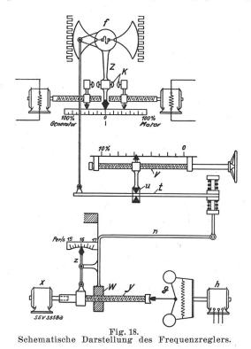
Lage der Stellung der Schwunggewichte des Drehzahlpendels gegenüber dem Kontaktorgan des Reglers ist der eine Arm des Winkelhebels n mit einer Wandermutter w ausgerüstet, die auf der Welle des Drehzahlpendels verschiebbar ist. Diese Verschiebung der Wandermutter auf der Pendelwelle y erfolgt durch einen Hilfsmotor x, der die Welle
