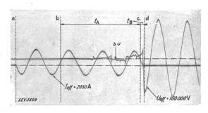
Fig. 3. Strom- und Spannungsverlauf bei Abschaltung von 2050 A unter 170 kV mit einem Oelstrahlschalter.
