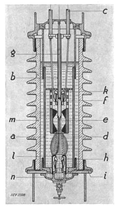
Fig. 2. Schnitt durch Schaltkammer eines Oelstrahlschalters für Höchstspannung.
