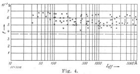
Lichtbogendauer eines Oelstrahlschalters von 150 kV in Funktion der Stromstärke.
