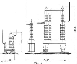
Abmessungen der Oelstrahlschalter für 64 und 220 kV Nennspannung.
