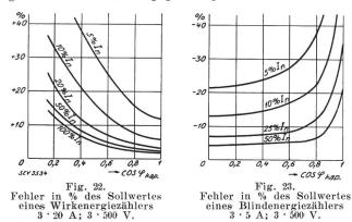
Fehler an den Wirkenergiezählern bei kapazitivem Bezug. Fig. 22 zeigt die an einem Kilowattstundenzähler für 3 · 500 V und 3 · 20 A aufgenommenen Fehlerkurven. Danach können Fehler bis zu ca. 40 %
