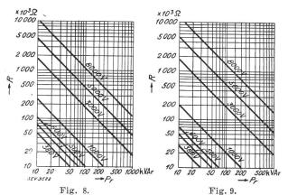
Maximal-Widerstand, wenn der Kondensator nach höchstens 10 s eine Spannung von 36 V erreicht haben soll.
