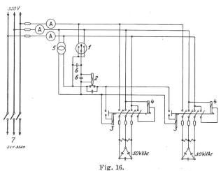
Schema eines Asynchronparallelbetriebes.
