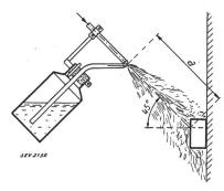
Fig. 6. Zerstäuber für die Bespritzung.  $a=40~\mathrm{cm}.$
