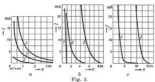
strom I (50 Per./s.) in Funktion des Abstandes zwischen der Strahlrohrmündung und dem angespritzten Leiter a (m).
