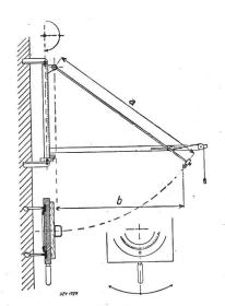
Fig. 2. Apparat zur Prüfung der mechanischen Festigkeit. a = 100 cm; b = 71 cm.
