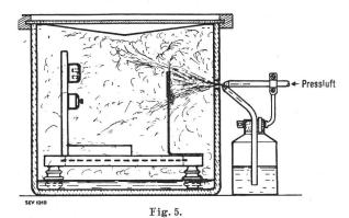
Abschlusskasten und Zerstäuber für die Prüfung der Feuchtigkeitsbeständigkeit.
