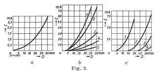
Strom I (50 Per./s.) in Funktion des Strahlrohr-Mündungsdurchmessers D (mm).
