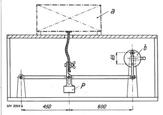
Fig. 1. Apparat für die Prüfung der Zugentlastung. P = Belastungsgewicht = 10 kg. a = Früfling. Masse in mm.
