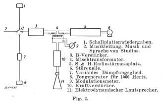
Messanordnung zur Bestimmung der Prozentwerte der unzu-lässigen Störung nach dem akustischen Verdeckungsverfahren mit Messton, der so eingestellt wird, dass bei reduzierter Lautsprecherempfindlichkeit die Störgeräusche beim Schwellwert des Tones gerade verdeckt werden.
