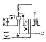
Fig. 15. Kupferoxydul-Gleichrichter in Spannungsverdopplerschaltung.
