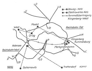
Fig. 1. Schematischer Netzplan für Leistungsregelung Kraftwerk West der BEWAG.
