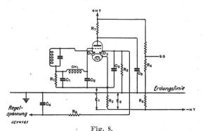
Schaltung für verstärkte Regelgleichspannung.
