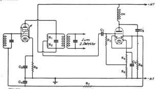
Fig. 11. Schaltung für verzögerten Schwundausgleich mit zusätzlicher Hochfrequenzstufe für grosse Regelspannung.
