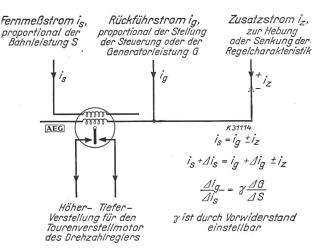
Fig. 2. Schema der Leistungsregelung.
