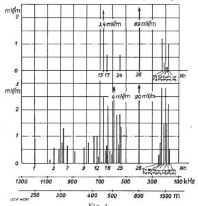
Fig. 1. Feldstärkenstatistik für Genf (Plaine de Plainpalais). Oben: Tagesfeldstärken am 22. u. 23. März 1934, 14.00 bis 18.00 h. Unten: Nachtfeldstärken am 22. u. 23. März 1934, 20.00 bis 24.00 h. Abszisse: Senderfrequenz in kHz, bzw. Wellenlänge in m. Ordinate: Feldstärke in mV/m.
