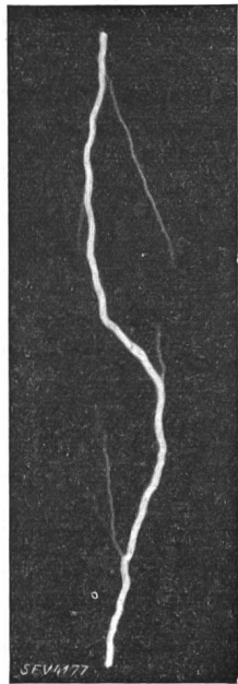
Fig. 7. Stossfunke zwischen Spitzenelektroden, bei ca. 3 Millionen Volt. (Laboratoire Ampère, Paris.)
