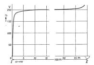
Fig. 4. Verlauf d. Spannung an der Erdoberfläche zwischen Elektrode I und Erde von Elektrode I bis Elektrode (II); Abstand der Elektroden 100 m, Radius  $a_1 = 10 \text{ cm}$ ,  $a_{11} = 100 \text{ cm}$ .
