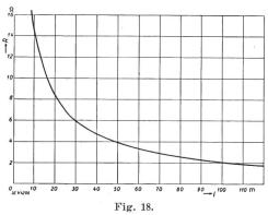
Widerstand (R) in Abhängigkeit von der Elektrodenlänge (l) für Bandelektrode von  $30\times3$  mm² Querschnitt bei einem spezifischen Erdwiderstand von  $10\,000\,\Omega\,\frac{\mathrm{cm}^2}{\mathrm{cm}}$
