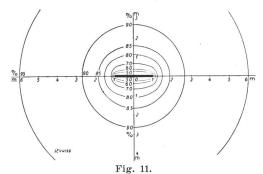
Spannungsverlauf einer an der Erdoberfläche liegenden Rohrelektrode in % der auf den Widerstand der Elektrode entfallenden Spannung.
