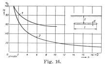
Aenderung des Widerstandes einer horizontal verlegten Elektrode bei Vergrösserung:
