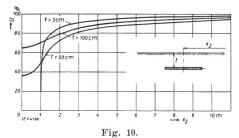
Spannung in % der an der Erdung liegenden Spannung an der Erdoberfläche für verschieden tief eingegrabene, horizontal verlegte Rohrelektroden, in der Axenrichtung der Elektrode gemessen.
