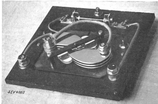
Fig. 2. Meßsystem eines elektrostatischen Voltmeters für 300 Volt, mit 2 Nadeln und eingebautem Schutzwiderstand.
