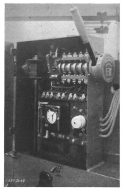
Fig. 9. Geöffneter Schaltkasten eines Oehler-Karrens.
