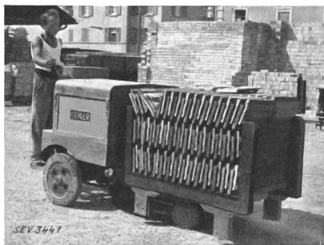
Fig. 7. Hubkarren beim Ziegeltransport, 1½ t.
