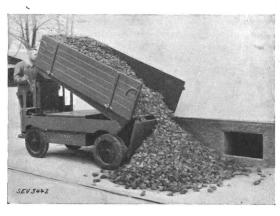
Fig. 8. Elektrokarren mit kippbarer Ladebrücke, 2 t.
