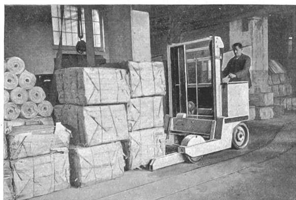
Fig. 15. Elektrostapler beim Abladen von Papierballen.
