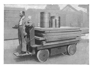
Fig. 17. Elektrokarren. Nutzlast 2000 kg.
