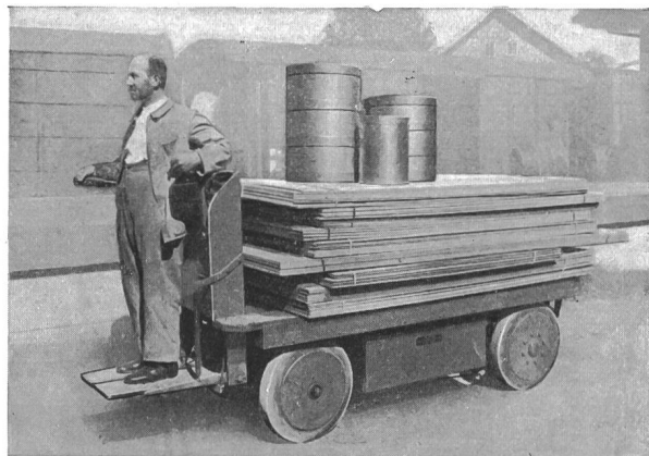
Fig. 17. Elektrokarren. Nutzlast 2000 kg.
