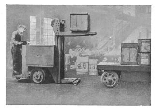
Fig. 14. Elektrostapler mit gehobener Last.
