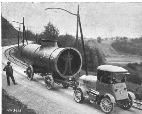
Fig. 3. Akkumulatortraktor. Zugkraft 10 t.
