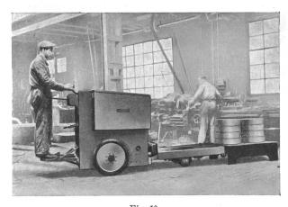
Fig. 10. Elektrohubwagen mit Ladebank.
