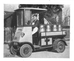
Fig. 4. Elektromilchkarren, 600 kg.
