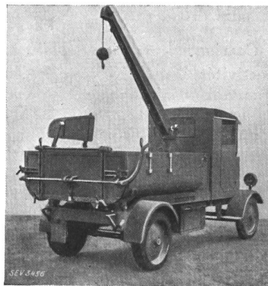
Fig. 14. Tracteur électrique à benne basculante, utilisé par le Service des Egouts de la Ville de Lyon.
