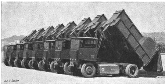
Fig. 11. Véhicules électriques employés à Lyon pour l'enlèvement des ordures ménagères.
