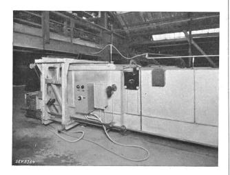
Moderner Elektrokühlofen mit durchlaufendem endlosem Band. (Einlegeende entsprechend 8 in Fig. 24.)
