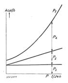
Fig. 20. Funktion  $P_t = f(P) = P_0 + \alpha P + \beta P^2$  für Oelwannenöfen. Anschauliche Aufteilung der Kurve Pt:
