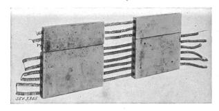
Fig. 27. <sup>27</sup>) Heizkörper der Seitenwände zu Elektroofen Fig. 25. Die Platten, die Heizwiderstände aus Nichrome-Metall enthalten, bilden die Seitenwände des Kühlofens innerhalb der ersten 1,8 Meter.
