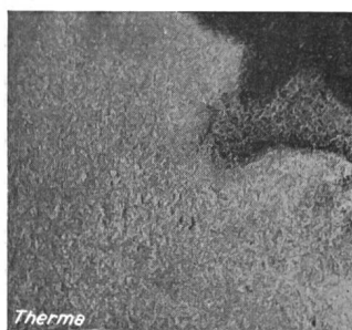
Fig. 25. Von Zitronensäure angegriffene Emaille. Vergrößerung ca. 5fach.
