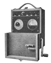
Fig. 1. Ansicht des Erdwiderstandmessers.
