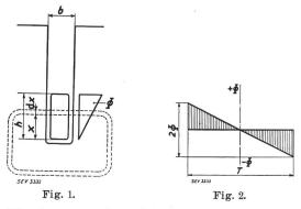
Die Ampèrestäbe nehmen von null bis zu einem maximalen Werte geradlinig zu, die Stabzahl zur
