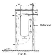
$d=\min$ . 8 cm für Heisswasserspeicher über 100 Liter Inhalt.  $d=\min$ . 4 cm für Heisswasserspeicher bis 100 Liter Inhalt.
