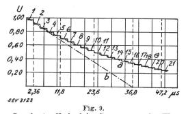
a Gerechneter Verlauf der Spannung an den Klemmen des Stossgenerators, der mit einer Leitung unendlicher Länge verbunden ist. Die Zahlen bei den einzelnen Stufen sind die Ordnungszahlen der Entladewellen im Kabel.
