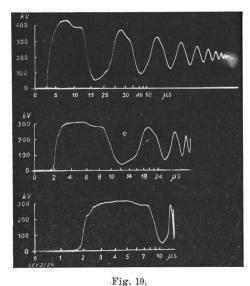
Oszillogramm des am Leitungsende reflektierten positiven Spannungsstosses. Die drei Kurven sind drei Oszillogramme mit verschiedenen Zeitmaßstäben; das oberste Oszillogramm ist bei höherer Stoßspannung aufgenommen als die beiden andern.
