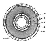
Fig. 3. Querschnitt des Kabels für 350 kV Gleichspannung.
