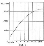
Isolationswiderstand des Kabels in Funktion der Zeit.
