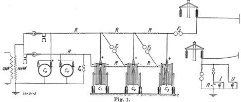
Schema des Kabel-Stossgenerators.
