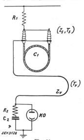
Fig. 14. Spannungsteilung nach Gábor. Zeitkonstante  $T=R_1C_1=R_2C_2$  Wellenwiderstand  $Z_v=R_2$  Laufzeit einer Welle über Kabel  $C_1=T_s$  Laufzeit einer Welle über Kabel  $Z_v=T_v$
